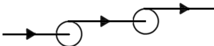
Рис. 5.9 – Последовательное соединение двух насосов и их совместная работа на трубопроводную сеть
