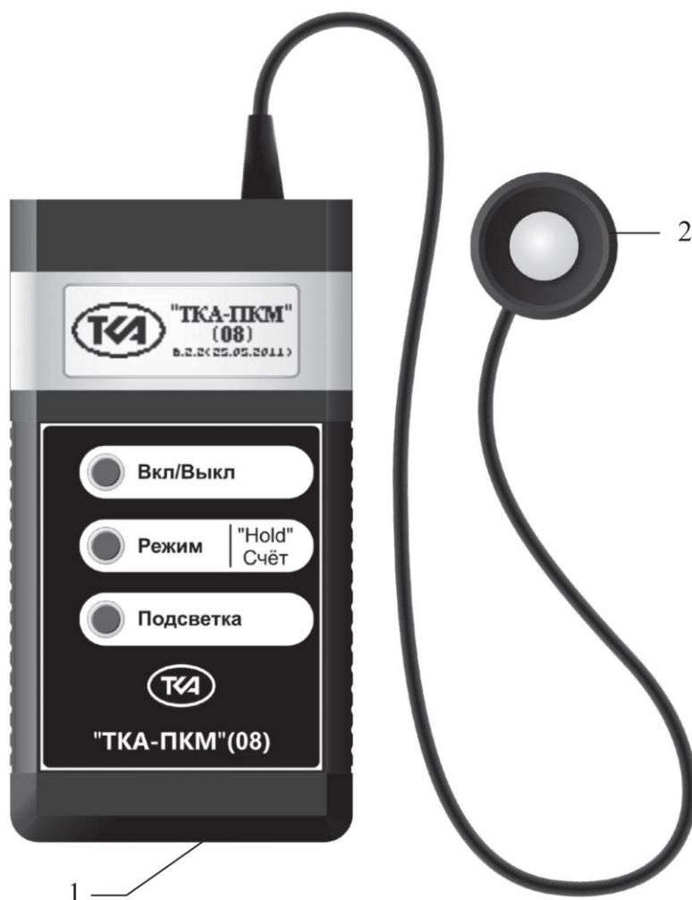
Рис. 2.3. Общий вид люксметра-пульсметра ТКА-ПКМ (08): 1 – блок обработки информации (БОИ); 2 – измерительной головки (ИГ).
