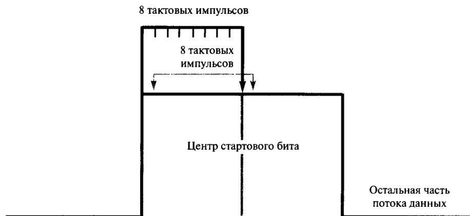
Рис. 2.11. Минимизация ошибок с использованием коэффициента тактирования 16
