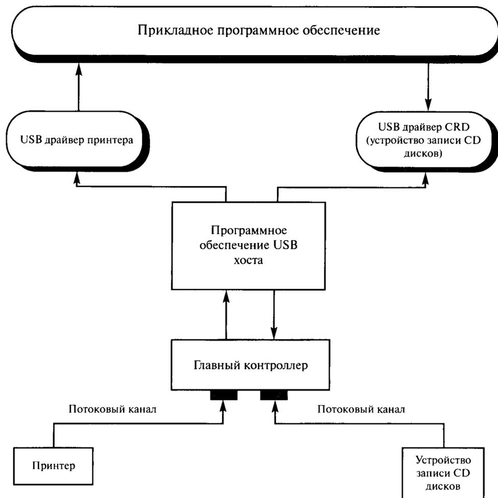
Рис. 3.41. Пример потоковой передачи данных
