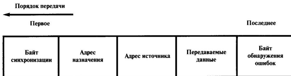
Рис. 1.2. Базовая структура информационного пакета, определяемого протоколом
