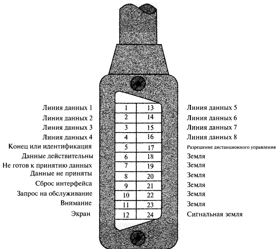
Рис. 3.27. Разъем стандарта GPIB и назначение контактов
