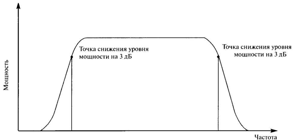
Рис. 7.2. Проблема ограничения полосы пропускания
