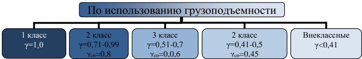
Рис. 1.3. Классификация грузов по требованиям, предъявляемым к конструкции автотранспортных средств: гамма — коэффициент использования грузоподъемности
