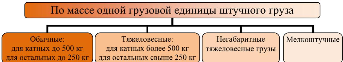
Рис. 1.4. Классификация грузов по условиям выполнения погрузочно-разгрузочных работ
