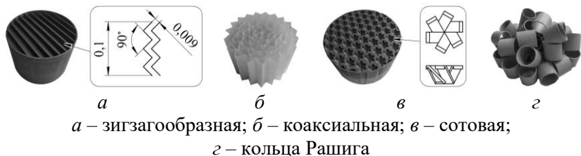
Рисунок 1 – Насадки для массообменных аппаратов
