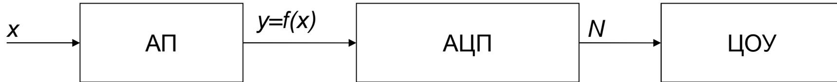
АП - аналоговый преобразователь, АЦП - аналого-цифровой преобразователь, ЦОУ - цифровое отсчетное устройство.
