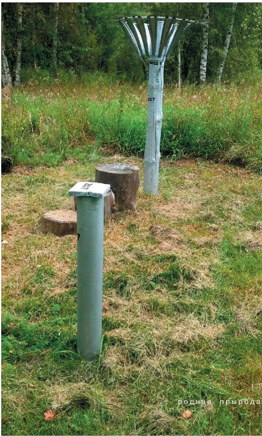
Скважина для наблюдений за уровнем болотных вод (1966 и 2017 годы).
