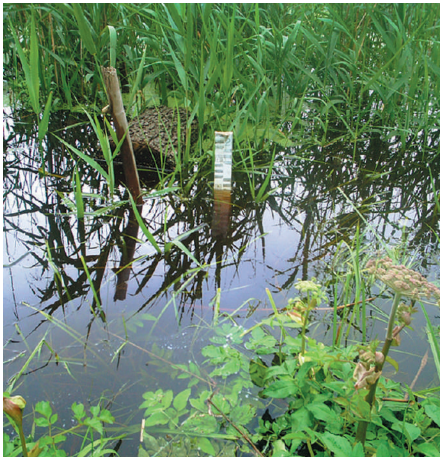
Водомерная рейка для наблюдения за уровнем воды на мелиоративном канале.
