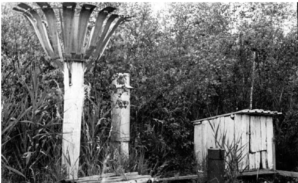
Скважина для наблюдений за уровнем болотных вод (1966 и 2017 годы).
