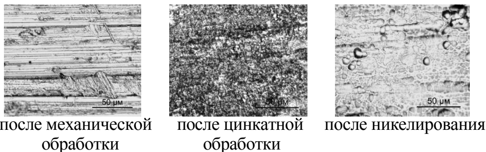
Рисунок 2 – Изменение профиля поверхности на разных этапах обработки
