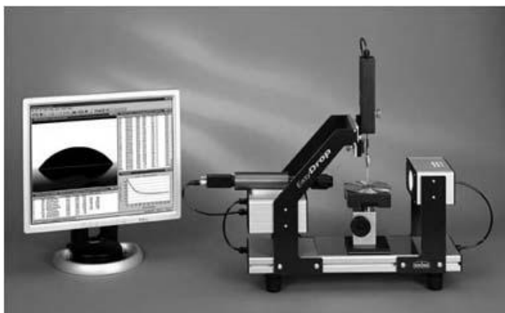
Рис 2. Общий вид прибора для измерения краевого угла смачивания «EasyDrop».
