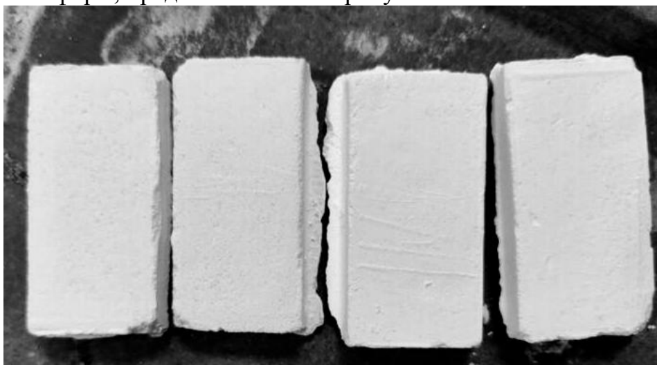
Рисунок 3 – Фото опытных образцов керамических литейных форм, обожженных при 1350 °С
