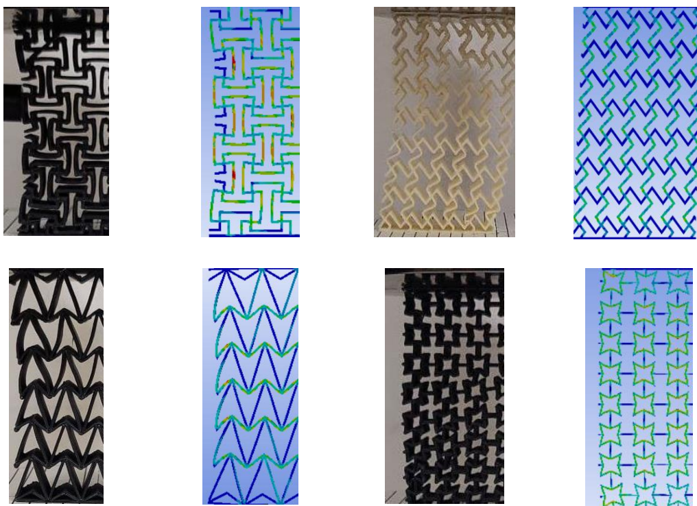
Рисунок 2 – Поведение образцов при испытании в области пропорционального деформирования и моделей при виртуальном нагружении
