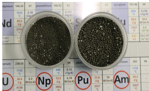
Внешний вид высокопрочных стеклокерамических пропантов
