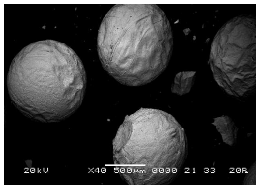
Поверхность высокопрочных стеклокерамических пропантов
